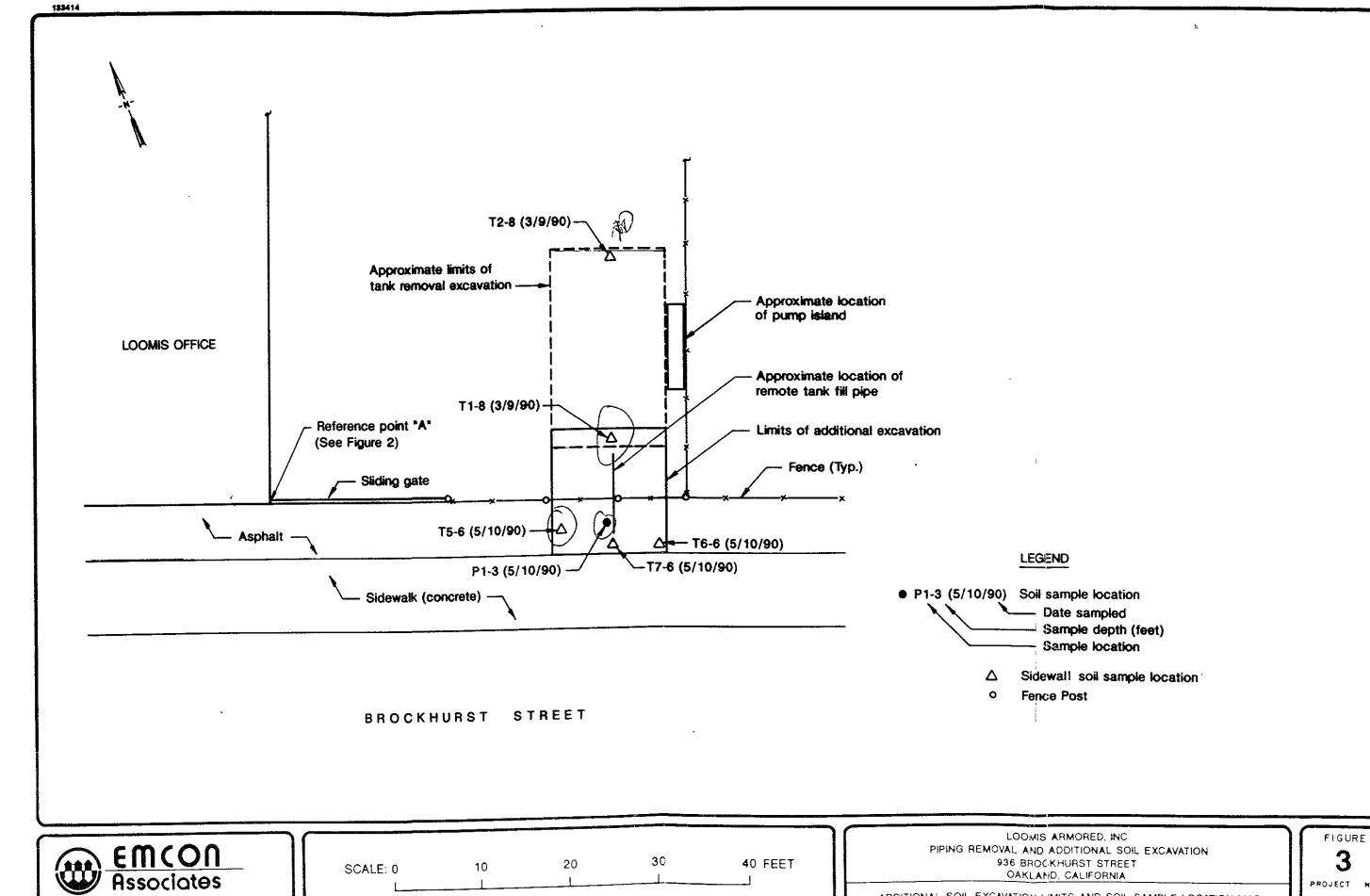
ADDITIONAL SOIL EXCAVATION LIMITS AND SOIL SAMPLE LOCATION MAP
