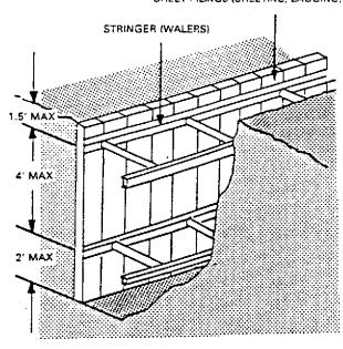
TYPICAL INSTALLATION IN HARD COMPACT SOIL-HYDRAULIC
