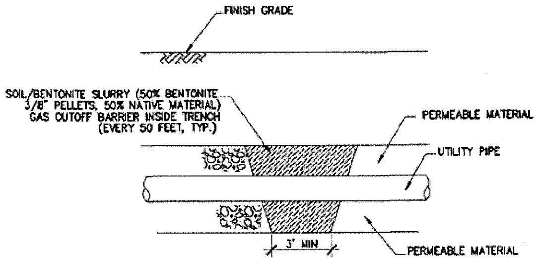
**D** UTILITY SOIL GAS CUT-OFF BARRIER IN UTILITY TRENCH
