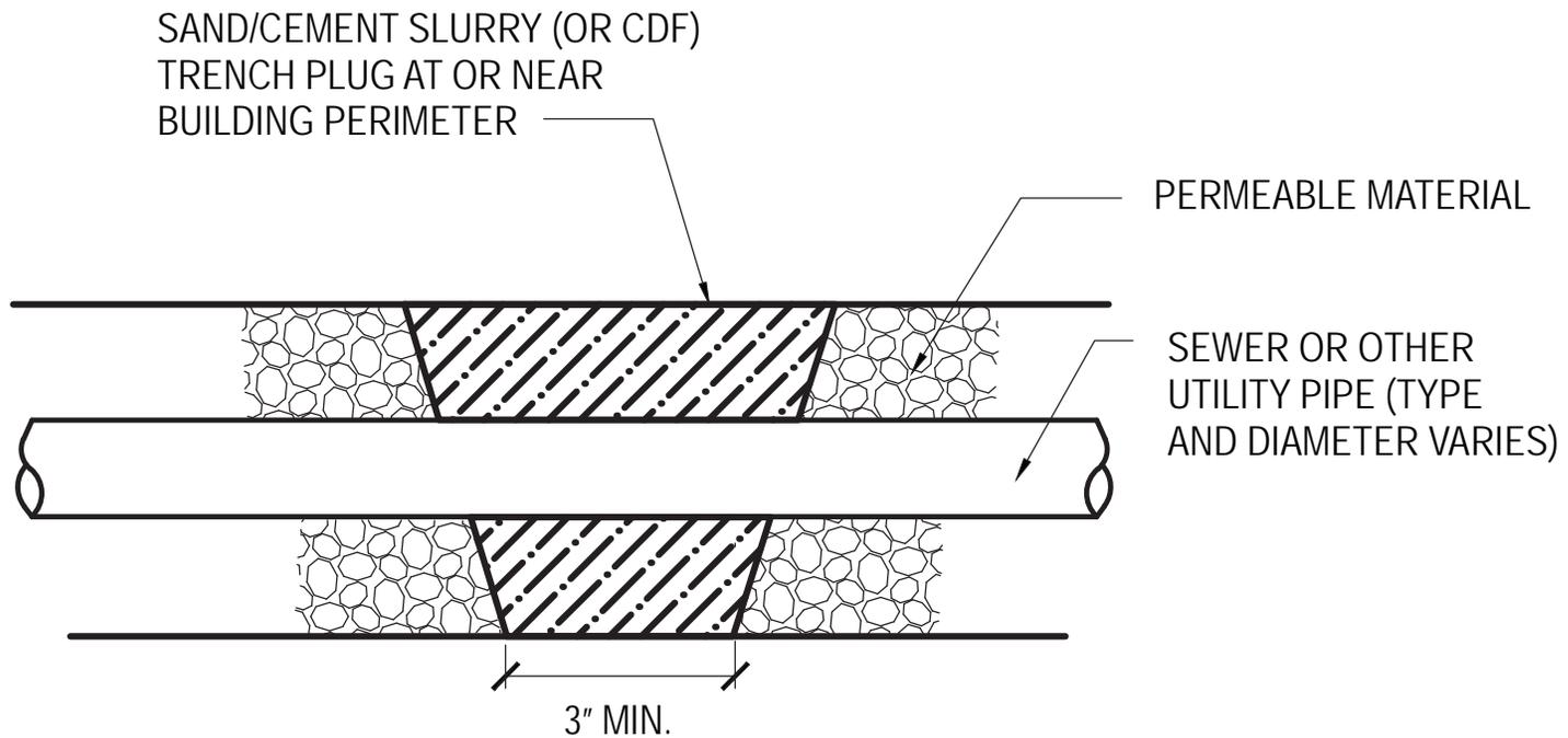
**TYPICAL SOIL GAS CUT-OFF BARRIER IN UTILITY TRENCH**
