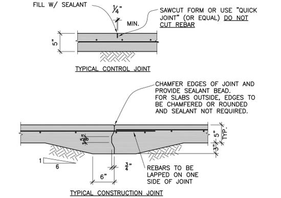
**2** TYP. SLAB ON GRADE JOINTS
