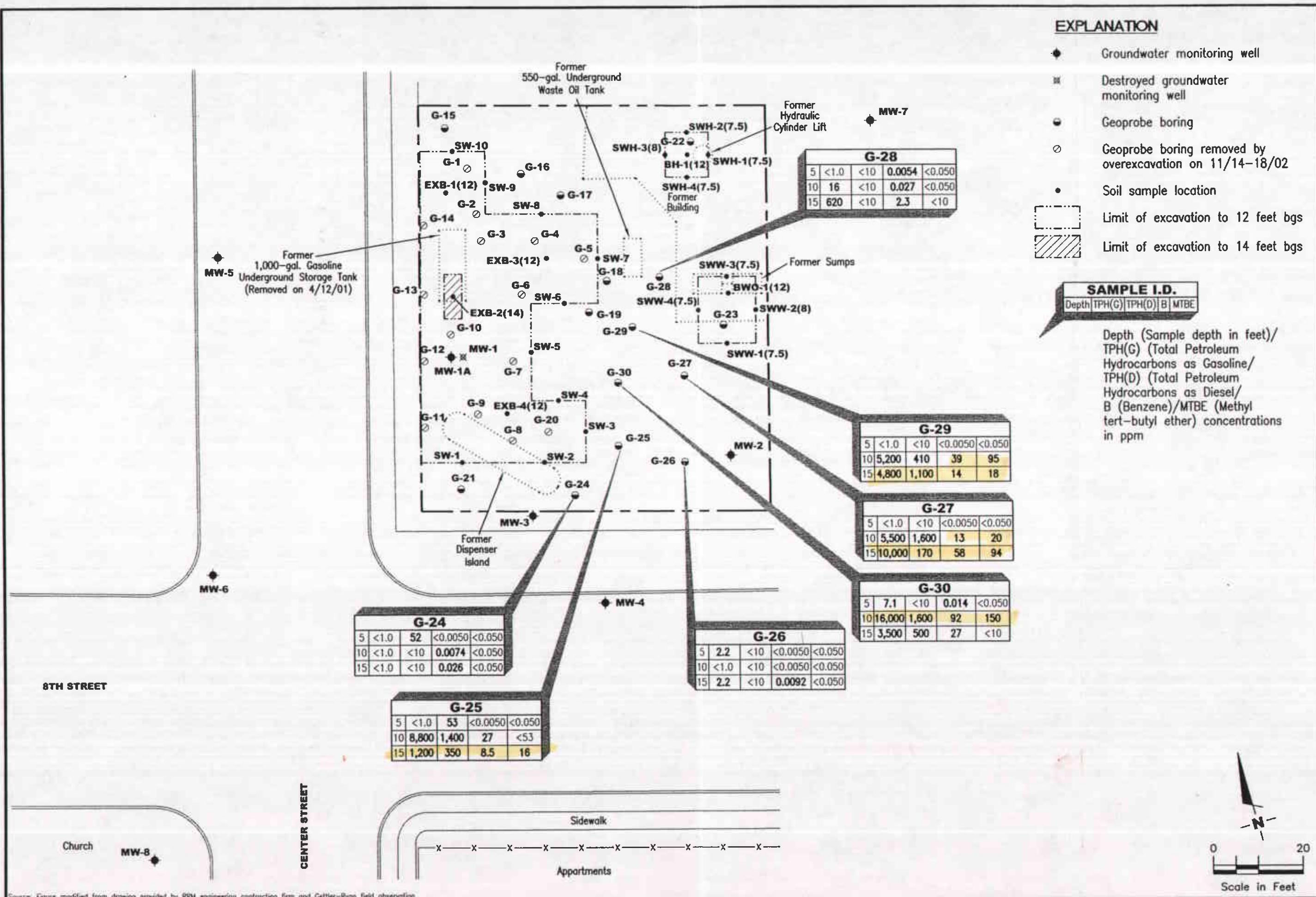
TABLE 4 - POST-OVER-EXCAVATION SOIL- SAMPLE CHEMICAL ANALYTICAL DATA - DISPENSER ISLAND AND GASOLINE UST AREA
